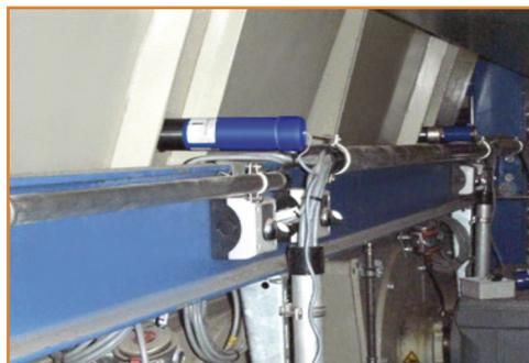
Rilevazione cemento in uscita bunker.
