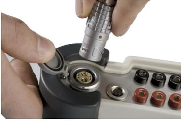
**Sensprom:** I parametri di calibrazione dei trasduttori vengono registrati in un microchip all'interno del connettore che li trasferisce all'elettronica all'atto della connessione. I trasduttori così possono essere intercambiabili tra loro.
